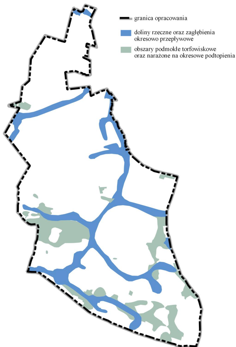
Ryc. 3. Obszary o niekorzystnych warunkach podłoża budowlanego
